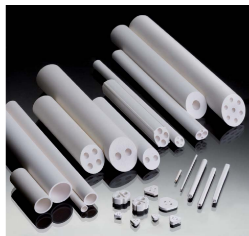
Bild 9 Typische Brechkeramiken auf Basis von MgO, kleinster Außendurchmesser in der Abbildung ist 1,7 mm, die größten Rohre haben einen Außendurchmesser von 25 mm
